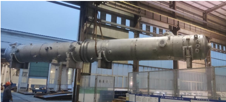
Zirconium Alloy -- UK; ASME + CE Mark; DN1500*19000
