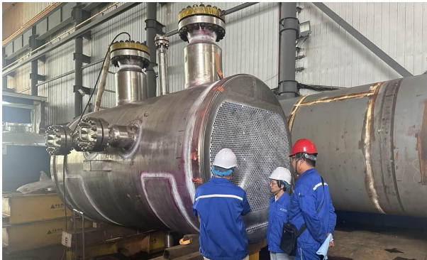
LNG Terminal – IFV DN1900*115*12000 120 ton (SS)
